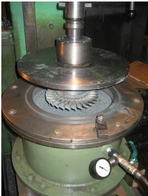
Рис. 3. Общий вид варианта промышленной установки для полирования деталей предлагаемым камерным способом в уплотненной обрабатывающей среде
