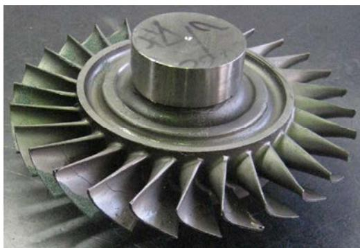
Рис. 2. Опытный образец детали (колесо турбины), использованный при проведении исследований
