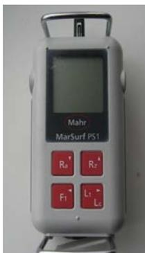
Рис. 4. Специальный прибор для измерения высоты микронеровностей поверхностей Mar Surf PS1 (Германия)
